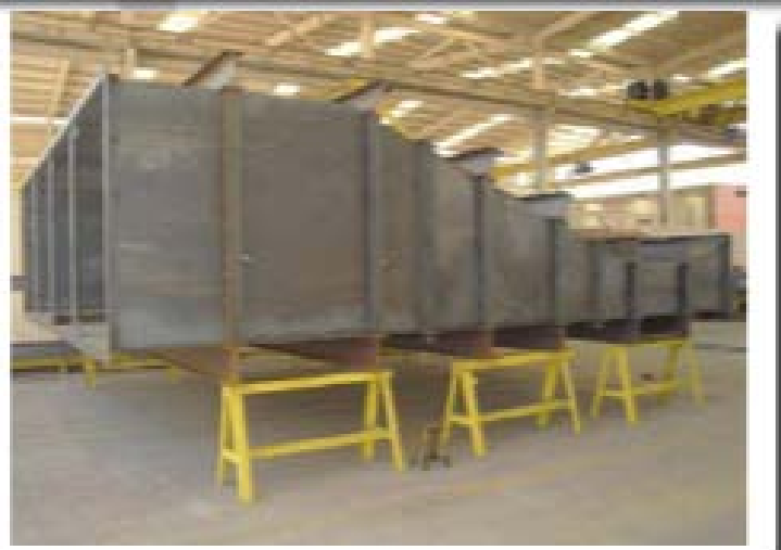
ESTRUCTURA METÁLICA PARA CHIMENEAS, DUCTOS EN CALDERAS DE RECUPERACIÓN.
